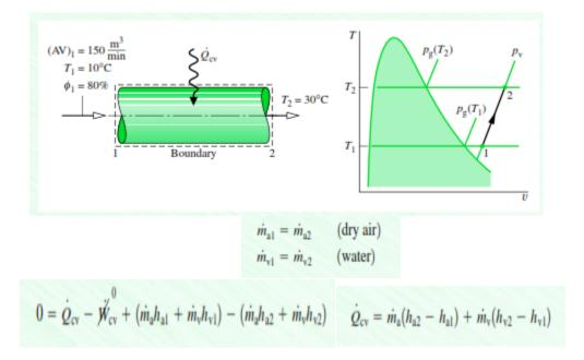
$$\dot{Q}_{\rm cv} = \dot{m}_{\rm a} [(\underline{h_{\rm a2} - h_{\rm a1}}) + \underline{\omega(h_{\rm v2} - h_{\rm v1})}]$$
