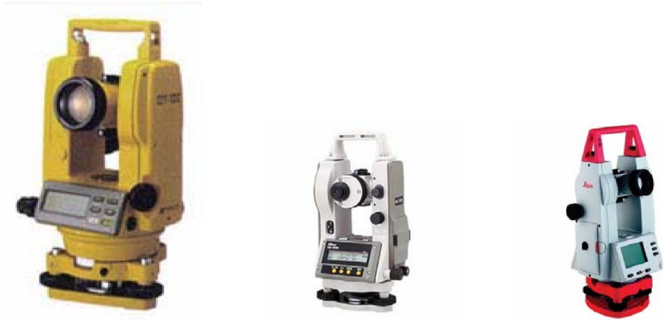
شكل (٥ - ١): اشكال مختلفة من اجهزة التيودوليت الرقمي
