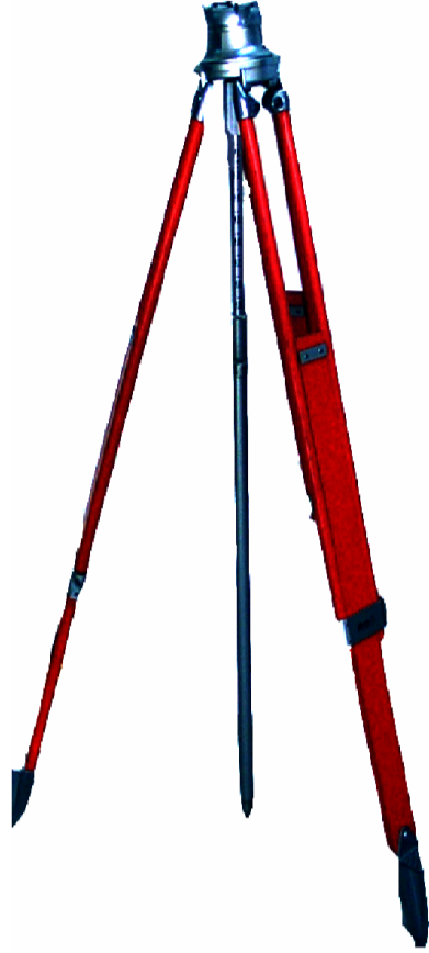
شكل (٤ - ٧): التسامت بقضيب التاسمت
